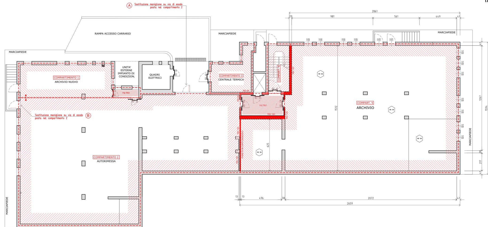
(A) Sostituzione maniglione su via di esodo posta nel compartimento 2
