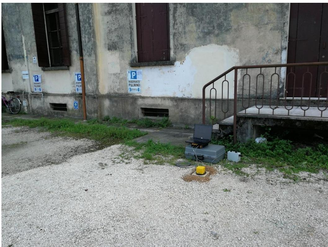
Foto 2 - Strumentazione utilizzata la misura HVSR: Dymas 24, sensore Veloget e cavi di collegamento.
