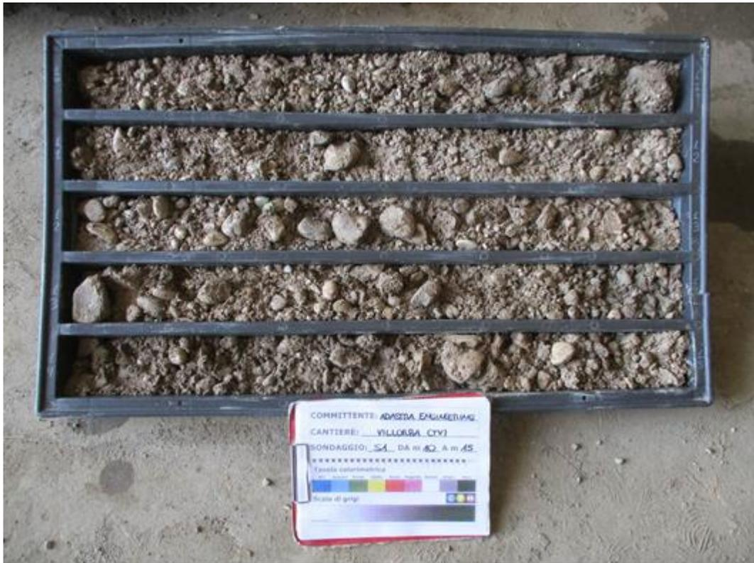
Foto 5 - Sondaggio S1 – Cassetta N. 3: da 10.0 m a 15.0 m.
