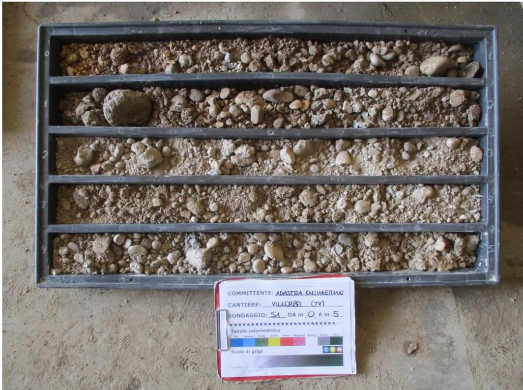
Foto 3 - Sondaggio S1 – Cassetta N. 1: da 0.0 m a 5.0 m.
