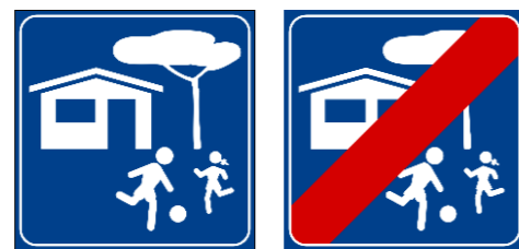
Figura 18 segnaletica di inizio e fine Zona a Traffico Residenziale
