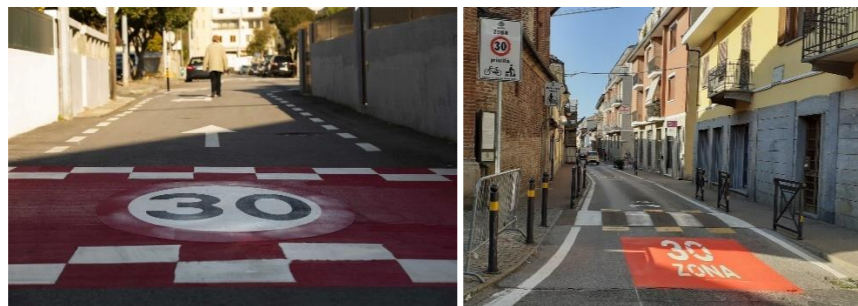
Figura 24: Segnaletica orizzontale e verticale per indicare l'inizio di una zona 30
