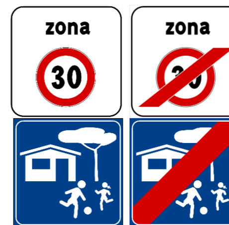
Figura 21 segnaletica di inizio e fine Zona 30
