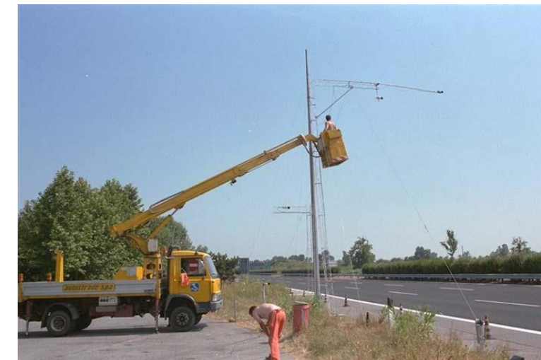
Foto 3 Sistema di array di microfoni utilizzati per la generazione della banca dati emissione dei veicoli
